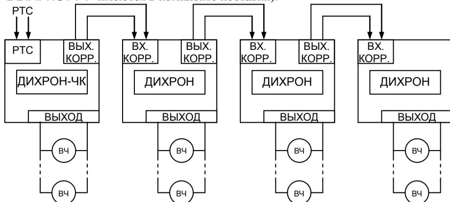
Суммарное сопротивление 2-х проводов между контактами «ВЫХ.КОПП.» предыдущих первичных часов и контактами «ВХ.КОПП.» последующих должно быть не более 150 Ом (800 м провода сечением 0,2 мм<sup>2</sup>).
