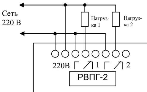
Подайте питание на реле. Для предварительной зарядки аккумулятора оставьте реле включенным в сеть на время не менее 8 час.
