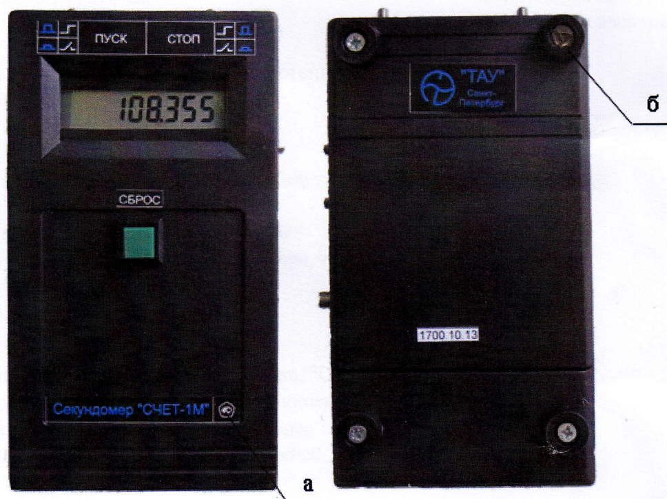
Рисунок 1 - Общий вид: а - место нанесения знака утверждения типа б - место пломбировки
