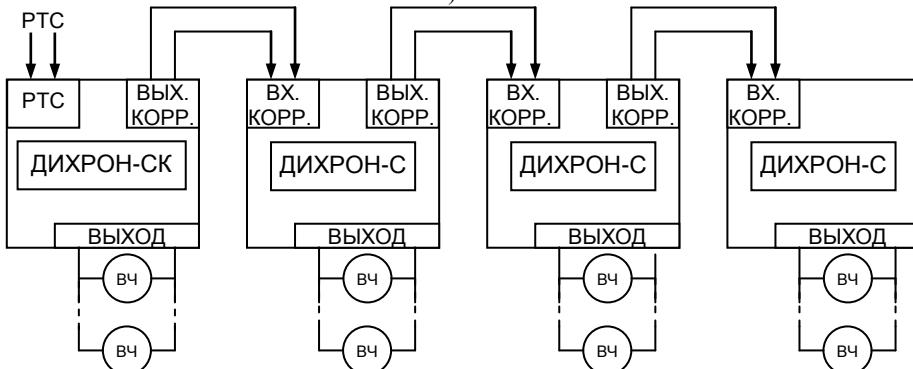
Суммарное сопротивление 2-х проводов между контактами «ВЫХ.КОРР.» предыдущих первичных часов и контактами «ВХ.КОРР.» последующих должно быть не более 150 Ом (800 м провода сечением 0,2 мм<sup>2</sup>).
